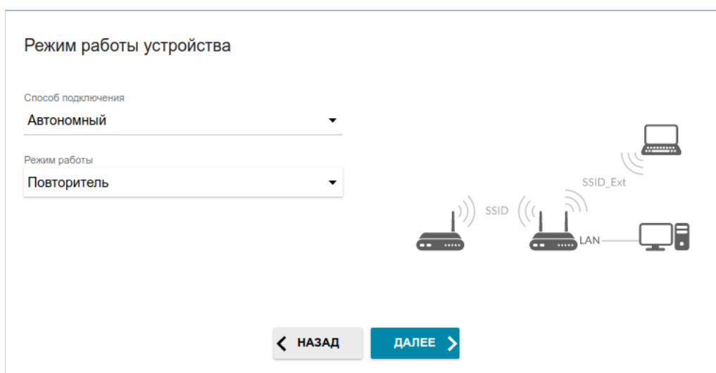
Рисунок 37. Выбор режима работы устройства. Режим Повторитель.
