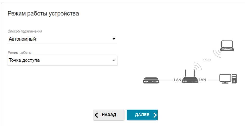
Рисунок 36. Выбор режима работы устройства. Режим Точка доступа.
