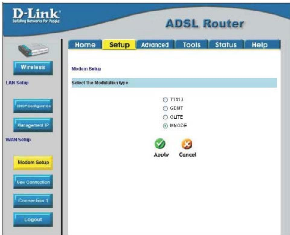
Рисунок 3-8. Меню Modem Setup (изменение типа модуляции)
