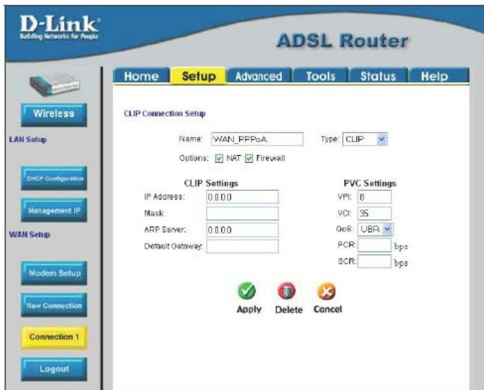
Рисунок 3-14. Меню Setup – настройка подключения Connection 1 для CLIP (IPoA)
