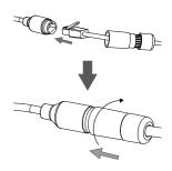
Поверните нижнюю часть водонепроницаемого коннектора по часовой стрелке для обеспечения герметичности Ethernet-кабеля.
