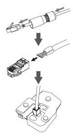
Соедините коннектор с разъемом RJ-45. Закрутите водонепроницаемый коннектор, повернув его приблизительно на пол-оборота по часовой стрелке.
