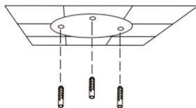
Просверлите отверстия глубиной приблизительно 25 мм сверлом диаметром 6 мм. Затем вставьте в отверстия анкеры.
