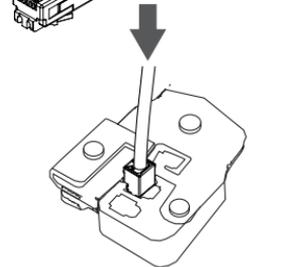
Соедините коннектор с разъемом RJ-45. Закрутите водонепроницаемый коннектор, повернув его приблизительно на пол-оборота по часовой стрелке.
