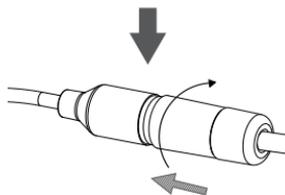
Поверните нижнюю часть водонепроницаемого коннектора по часовой стрелке для обеспечения герметичности Ethernet-кабеля.
