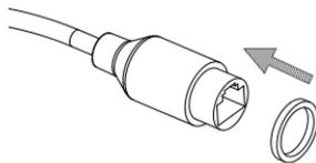
Протяните Ethernet-кабель через водонепроницаемый коннектор, как показано на рисунке. Далее вставьте кабель в коннектор RJ-45 и обожмите.
