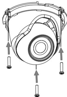
Прикрепите крышку основания камеры, выровняв канал по соответствующей отметке на основании камеры. Затем поверните крышку основания камеры по часовой стрелке до щелчка.
