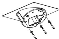
Снимите крышку основания камеры.
