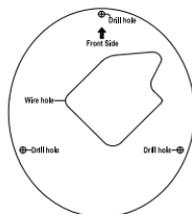
Используя монтажные отверстия на внутренней части кронштейна и входящие в комплект поставки винты, прикрепите DCS-37-3 к стене или потолку.
