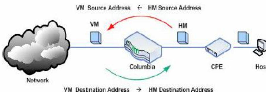
Рисунок 7-2. Сущность функции Virtual MAC.
