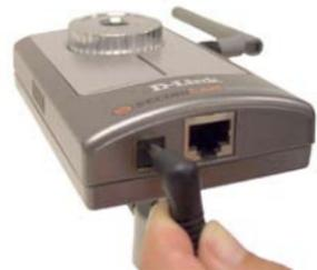
При первом включении устройства индикатор загорится красным светом. Индикатор не изменит свой свет на голубой, до тех пор пока камера не получит сетевой IP-адрес.
