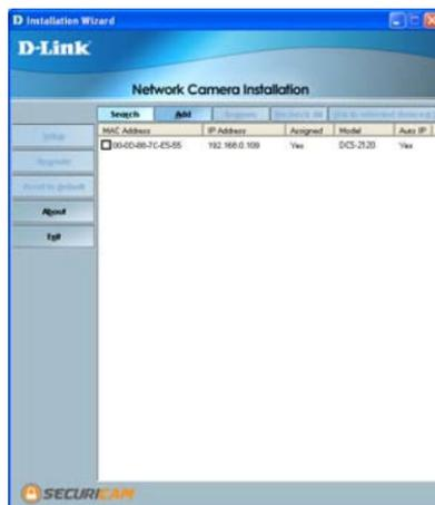
Если мастер не нашел ни одного устройства, необходимо перезагрузить камеру. Сброс настроек будет начат, когда кнопка Reset нажата один раз и индикатор Power начнет мигать. Восстановление настроек по умолчанию будет начато, когда кнопка Reset нажата в течение 30 секунд. При отпускании кнопки Reset индикатор будет мигать, указывая на возврат параметров DCS-2120 к заводским установкам.
