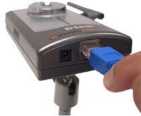
Подключите внешний источник питания к разъему постоянного питания, расположенному на нижней панели Интернет-камеры (обозначенному как DC 5V 2A) и подключите его к сетевой розетке переменного питания.
