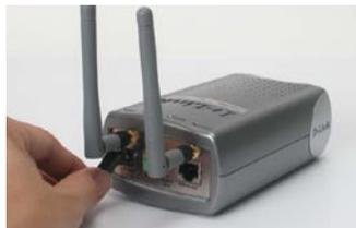
При правильном подключении индикатор на передней панели камеры изменит цвет с красного на зеленый. Индикатор может мигать и не мигать, и компьютер может показывать временную потерю связи, если он подключен непосредственно к камере. Это нормально и будет происходить до тех пор, пока Вы не настроите камеру.
