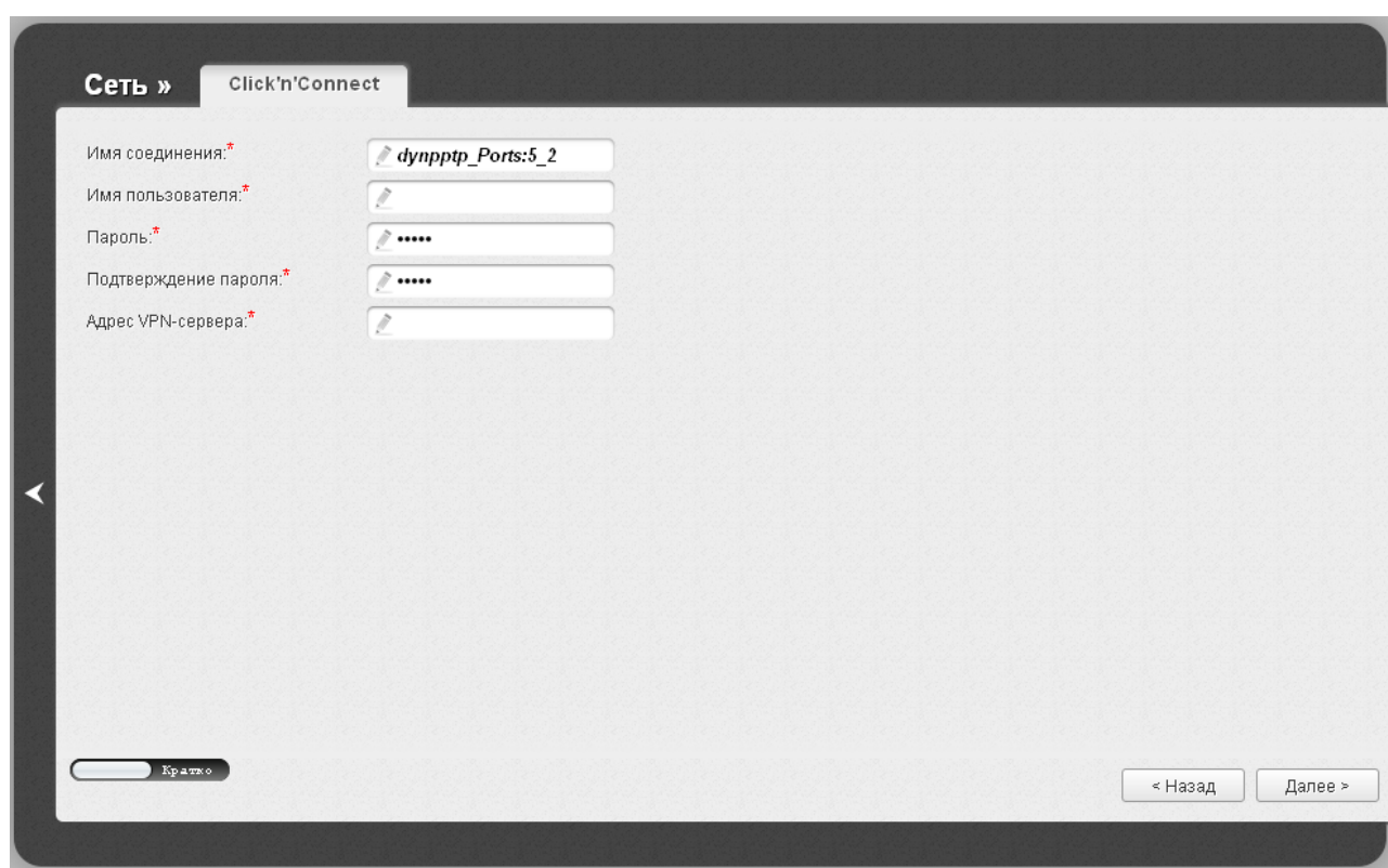
Рисунок 49. Настройка WAN-соединения типа PPTP + Динамический IP.
