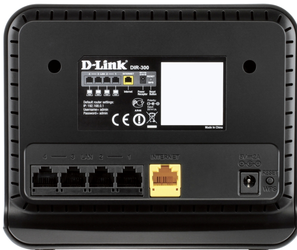
Рисунок 2. Вид задней панели DIR-300NRU.
