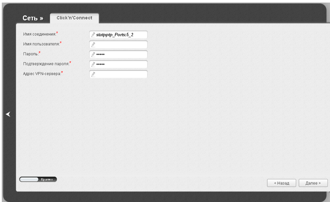
Рисунок 43. Настройка WAN-соединения типа PPTP + Статический IP.
