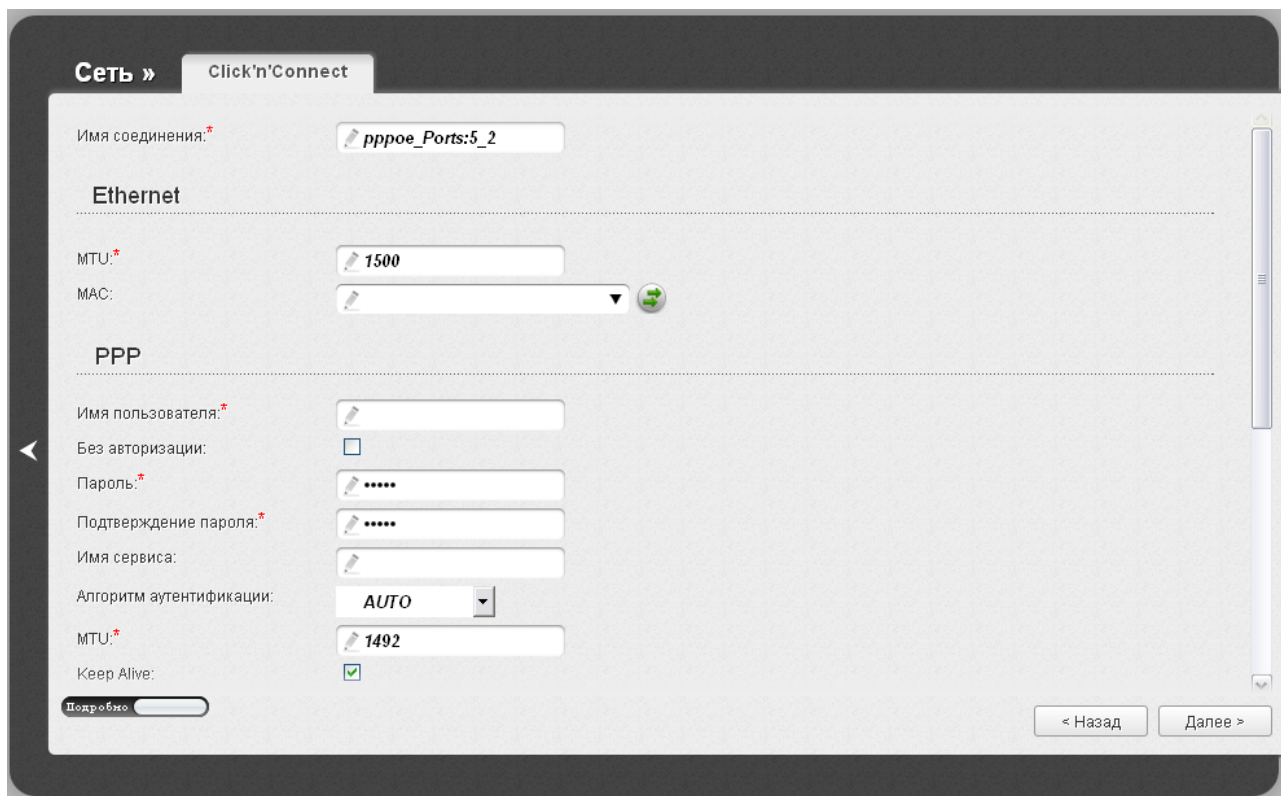
Рисунок 27. Настройка WAN-соединения типа PPPoE. Экспертный режим настроек. Раздел Ethernet.
