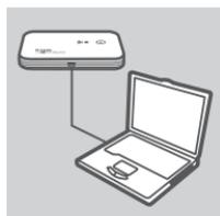
2. С помощью USB-кабеля, входящего в комплект поставки, подключите портативный маршрутизатор DIR-457 к компьютеру. Для этого подключите один конец USB-кабеля к Micro-USB-порту DIR-457, а другой конец к свободному USB-порту компьютера.
