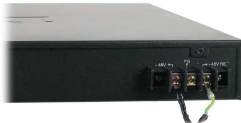
Рисунок 2.4 – Подключение коммутатора к источнику постоянного тока
