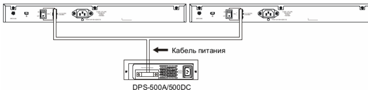
Рисунок 10 — Подключение двух коммутаторов к DPS-500A/500DC
