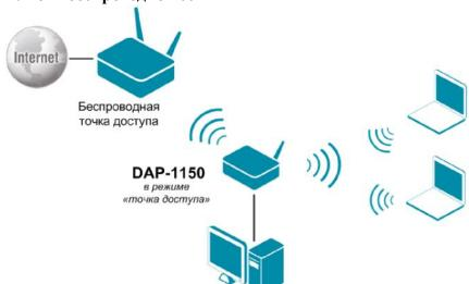
Устройство DAP-1150 в режиме «точка доступа» подключено к точке доступа по беспроводному соединению. Компьютеры подключаются к DAP-1150 через проводное или беспроводное соединение.
