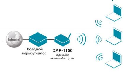
Устройство DAP-1150 в режиме «точка доступа» подключено к проводному маршрутизатору. Компьютеры, оснащенные Wi-Fi-адаптерами, подключаются к DAP-1150. Необходимо настроить одинаковые параметры шифрования и канал беспроводной сети для DAP-1150 и компьютеров с Wi-Fi-адаптерами.
