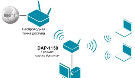
Устройство DAP-1150 в режиме «точка доступа» подключено к точке доступа по беспроводному соединению. Компьютеры подключаются к DAP-1150 через проводное или беспроводное
