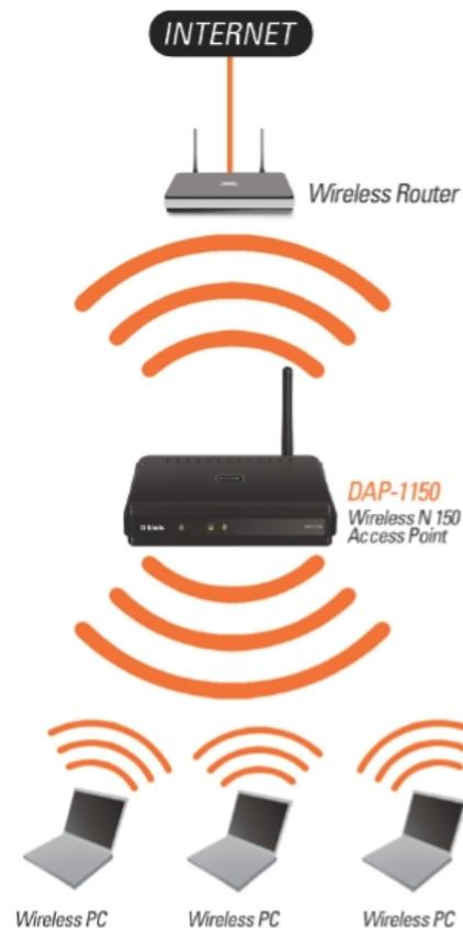
Расширение радиуса действия беспроводного маршрутизатора с помощью использования точки доступа DAP-1150/RU
