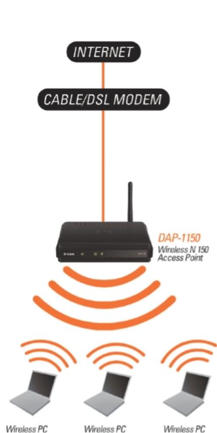
Беспроводные компьютеры подключаются к сети, используя DAP-1150/RU в качестве центральной точки подключения
