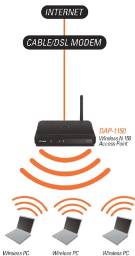
Беспроводной маршрутизатор предназначен для совместного использования Ethernet подключения
