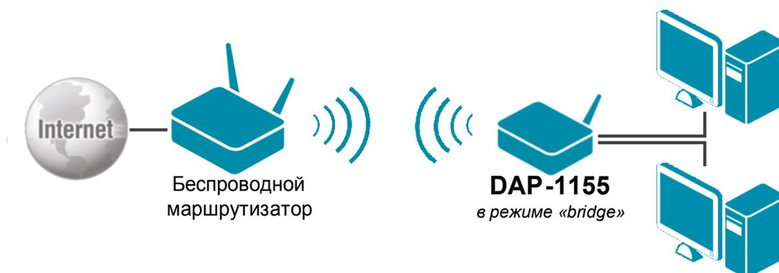
Подключите устройство к компьютеру кабелем, поставляющимся в комплекте. На сетевой карте, к которой подключено устройство, в настройках TCP/IP укажите IP-адрес – **192.168.0.51** и маску подсети – **255.255.255.0**.
