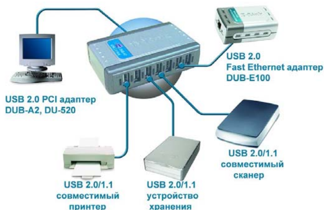
Типовое подключение устройств USB 2.0/1.1
