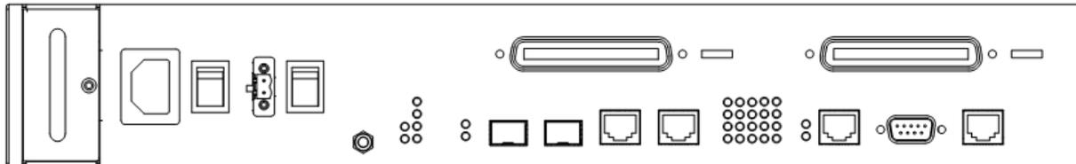
Рисунок 7. Передняя панель DAS-3626
