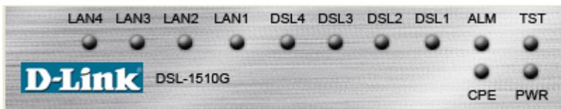
Рис. 3-1 Передняя панель DSL-1510G
