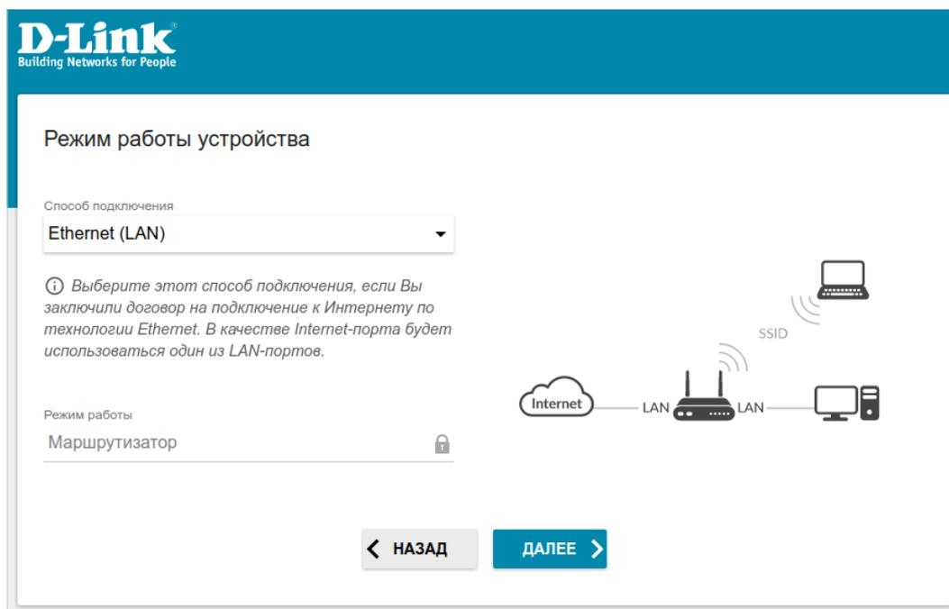
Рисунок 34. Выбор режима работы устройства. Способ подключения **Ethernet (LAN)**.
