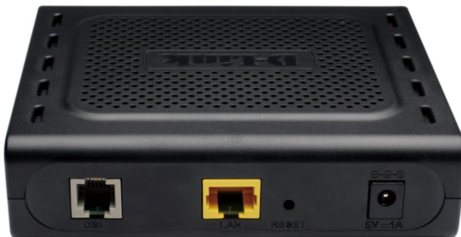
Рисунок 2. Вид задней панели DSL-2500U.
