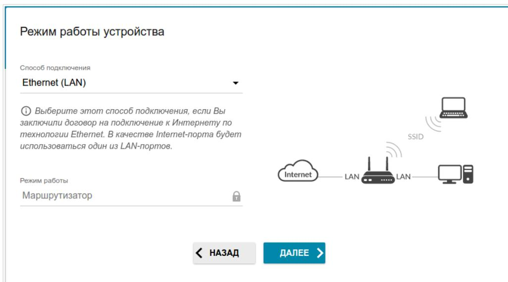
Рисунок 23. Выбор режима работы устройства. Способ подключения **Ethernet (LAN)**.
