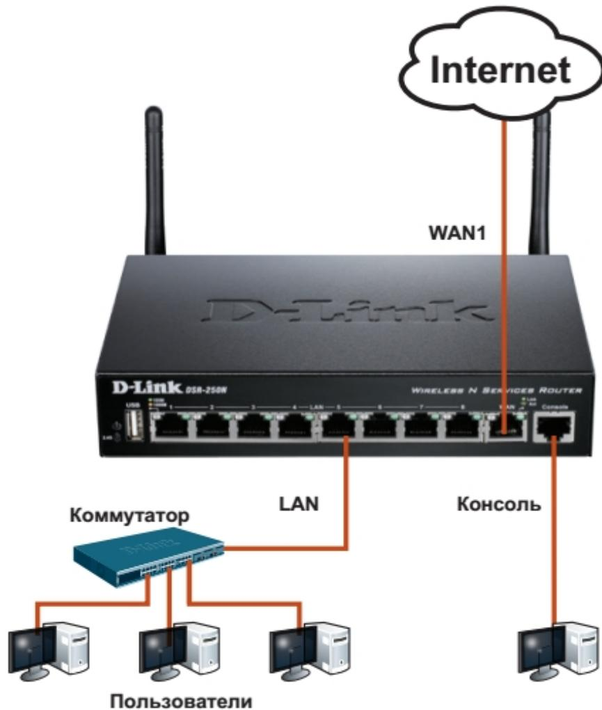
**Рисунок 3. Пример подключения кабелей**
