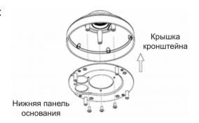
Выберите подходящее место на потолке для того, чтобы просверлить отверстие диаметром 34 мм (+2 / -0 мм). Используйте входящий в комплект поставки шаблон, чтобы разметить и вырезать монтажные отверстия.
