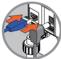
Подсоедините уже подключенный к IP-камере Ethernet-кабель к маршрутизатору. Подключите адаптер питания к розетке.
