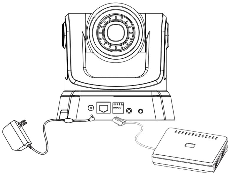
**Внимание:** После включения питания индикатор загорится красным. После получения устройством IP-адреса и доступа индикатор загорится зеленым.
