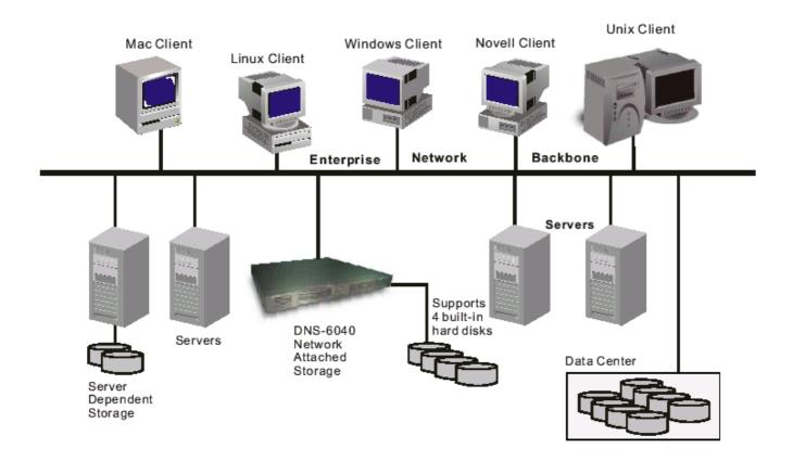
Подключение сетевого дискового массива ( Network Attached Storage) к сети Используя DNS-6040 Network Attached Storages (NAS), можно хранить файлы Windows, Netware, Unix, Linux и Мас форматов, предоставляя доступ к ним пользователям Windows, Netware, Unix, Linux и Mac.
