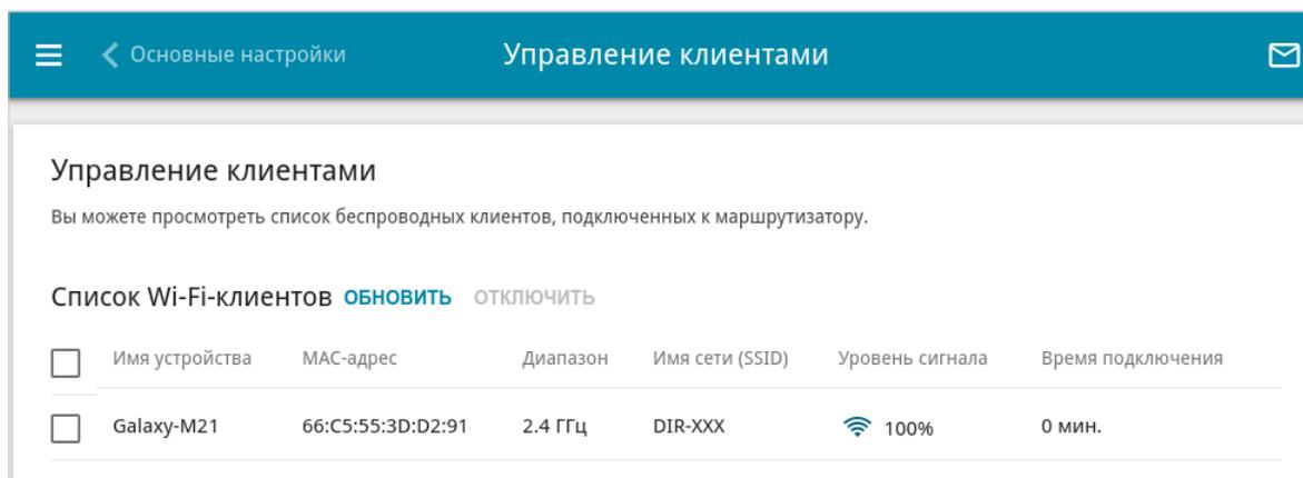
Рисунок 117. Страница для управления подключенными беспроводными устройствами.
