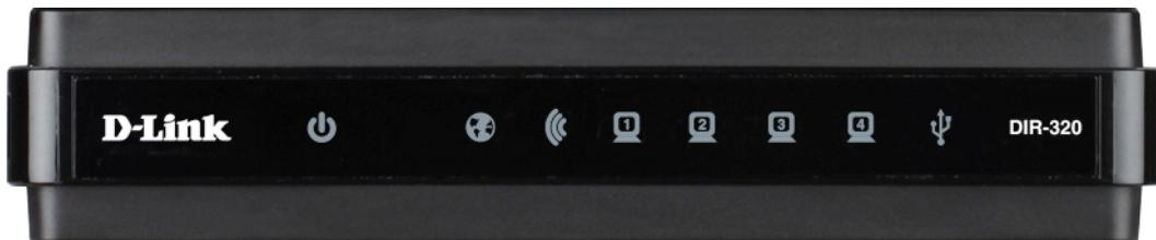
Рисунок 1. Вид передней панели DIR-320NRU.
