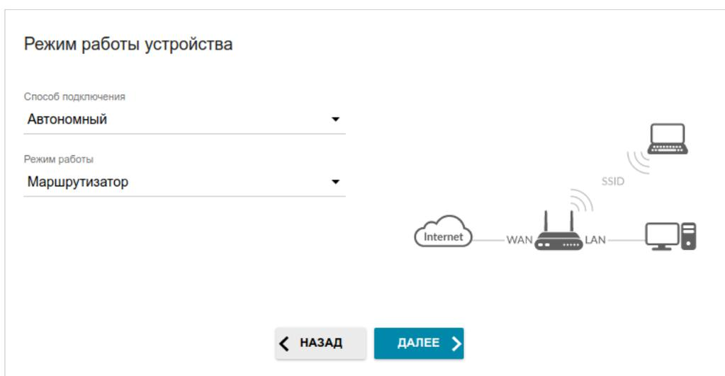
Рисунок 33. Выбор режима работы устройства. Режим **Маршрутизатор**.
