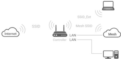
Рисунок 39. Настройка функции EasyMesh для главного устройства. Режим Повторитель WISP.
