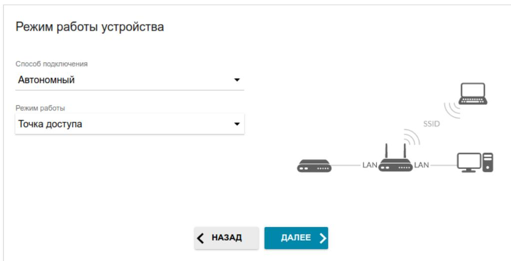
Рисунок 35. Выбор режима работы устройства. Режим Точка доступа.
