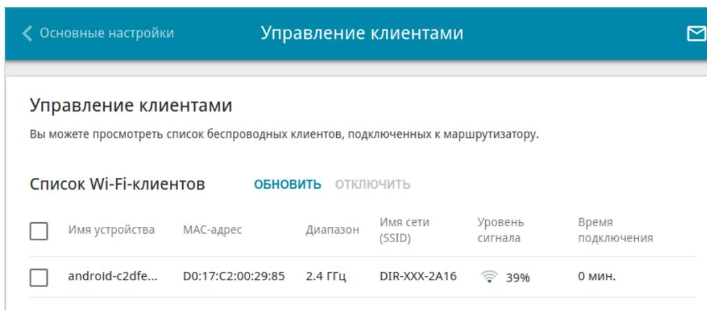
Рисунок 104. Страница для управления подключенными беспроводными устройствами.
