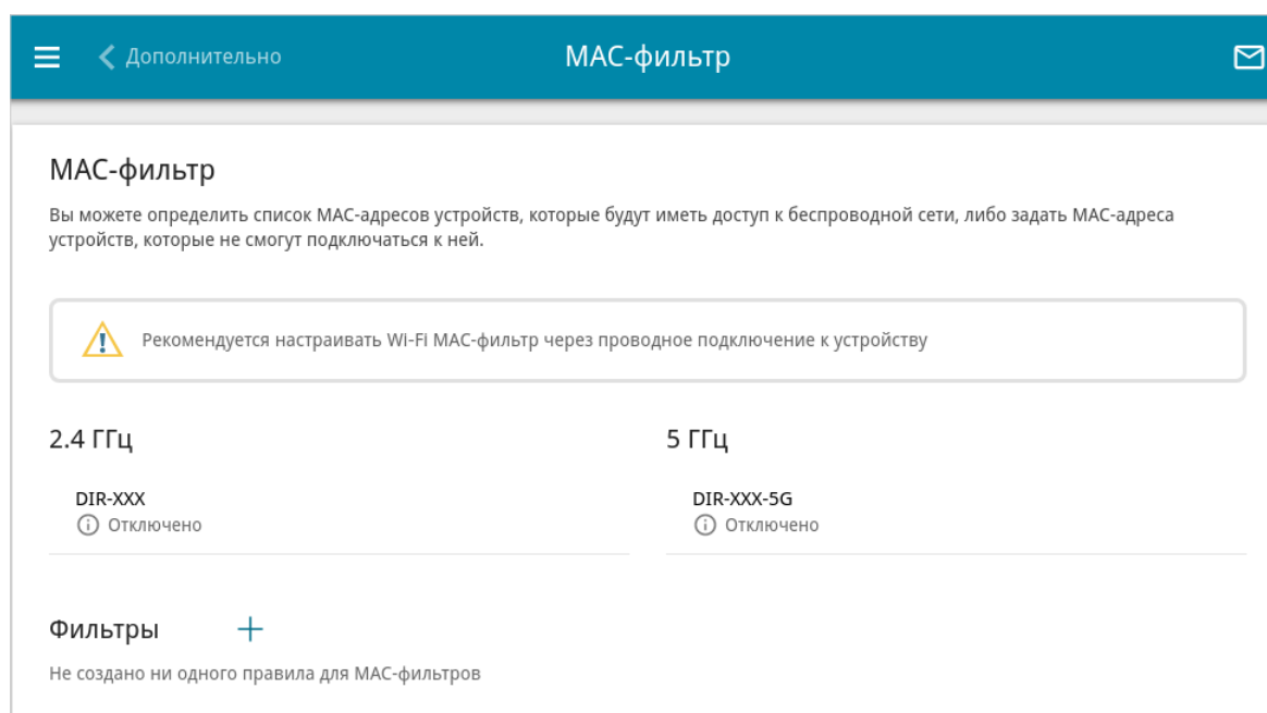
Рисунок 146. Страница для настройки MAC-фильтра для беспроводной сети.
