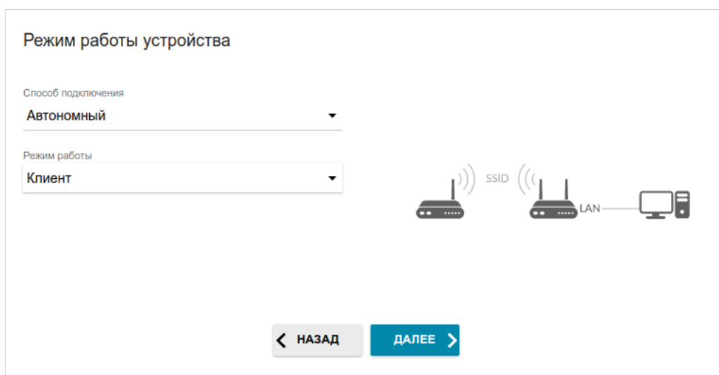
Рисунок 38. Выбор режима работы устройства. Режим Клиент .
