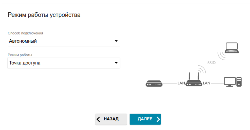
Рисунок 36. Выбор режима работы устройства. Режим Точка доступа .
