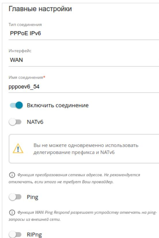
Рисунок 82. Страница добавления соединения типа **PPPoE IPv6**. Раздел **Главные настройки**.
