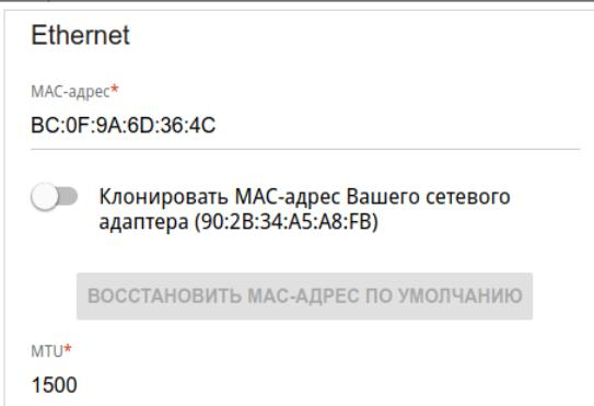
Рисунок 75. Страница добавления соединения типа **PPPoE**. Раздел **Ethernet**.
