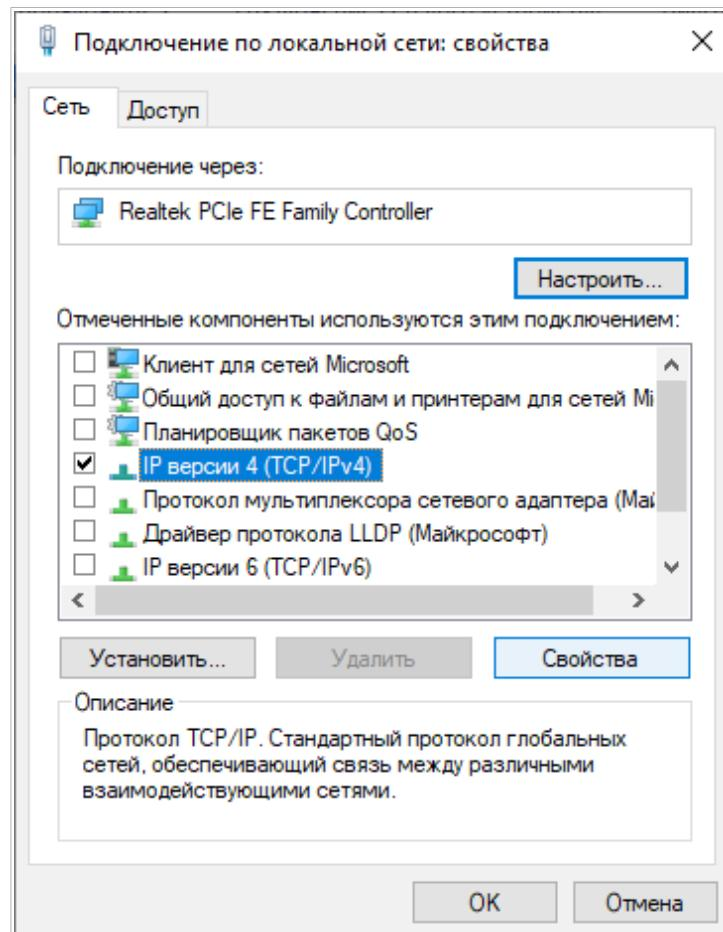
Рисунок 11. Окно свойств подключения по локальной сети.
