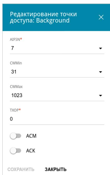
Рисунок 108. Окно для изменения параметров функции WMM.
