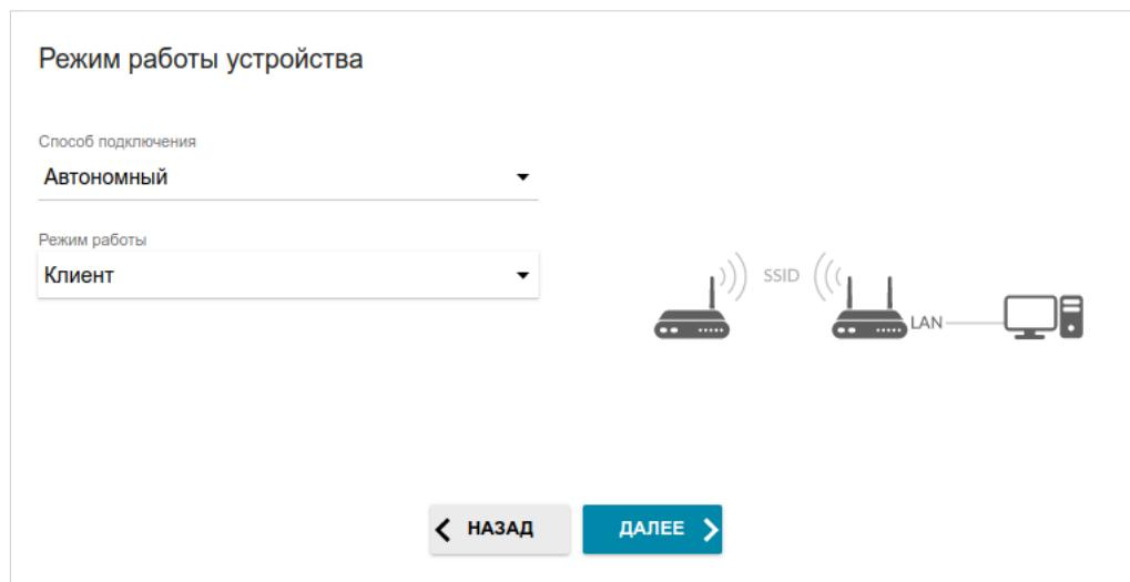
Рисунок 37. Выбор режима работы устройства. Режим **Клиент**.
