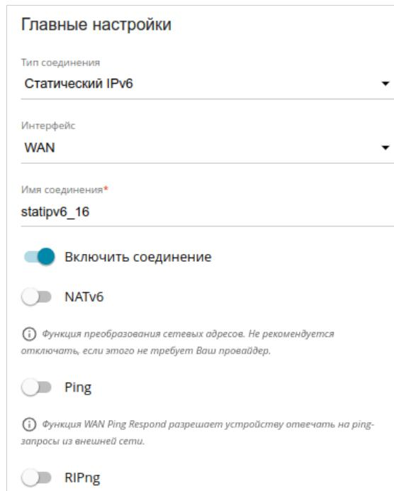
Рисунок 71. Страница добавления соединения типа **Статический IPv6**. Раздел **Главные настройки**.
