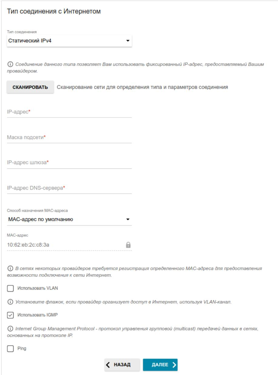
Рисунок 43. Страница настройки WAN-соединения типа Статический IPv4.
