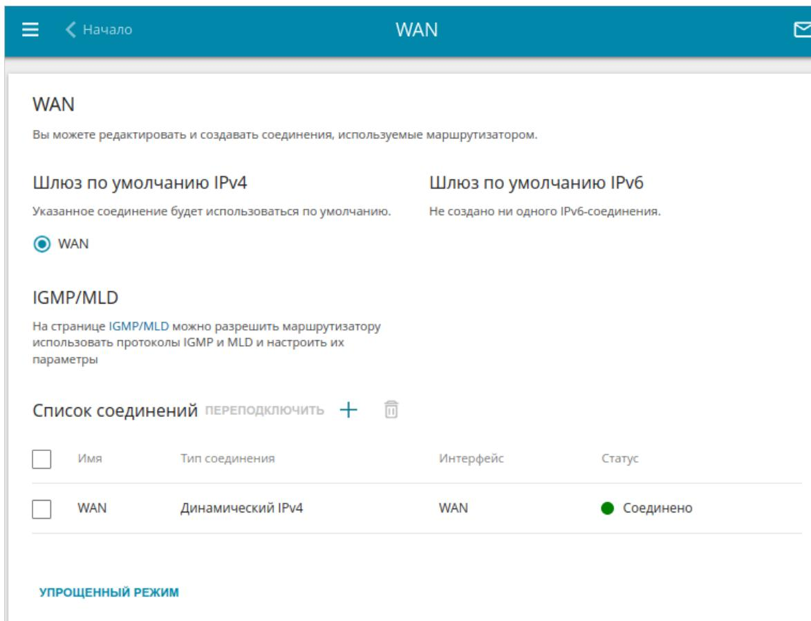
Рисунок 67. Страница **Настройка соединений / WAN**. Расширенный режим.
