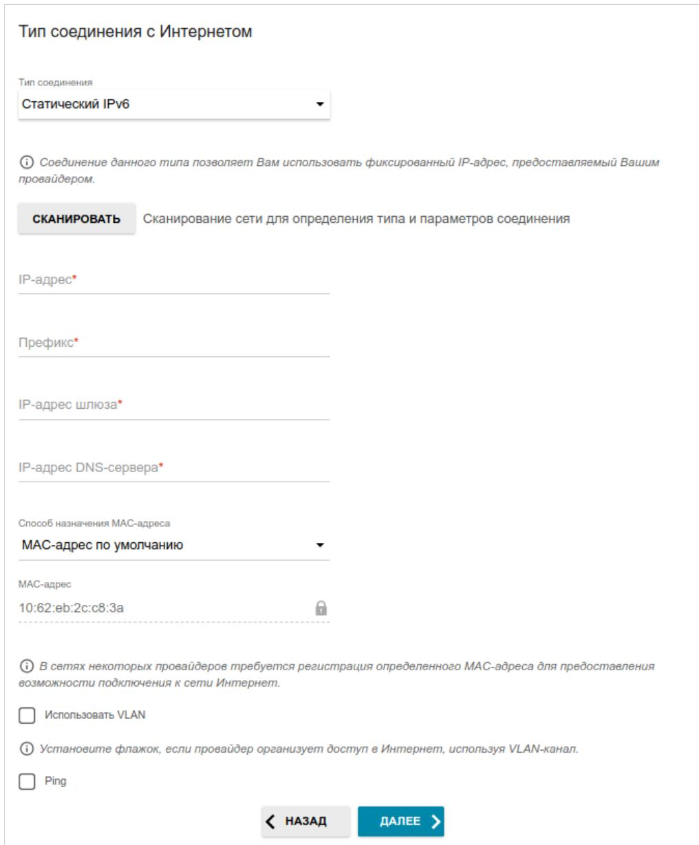
Рисунок 44. Страница настройки WAN-соединения типа Статический IPv6.
