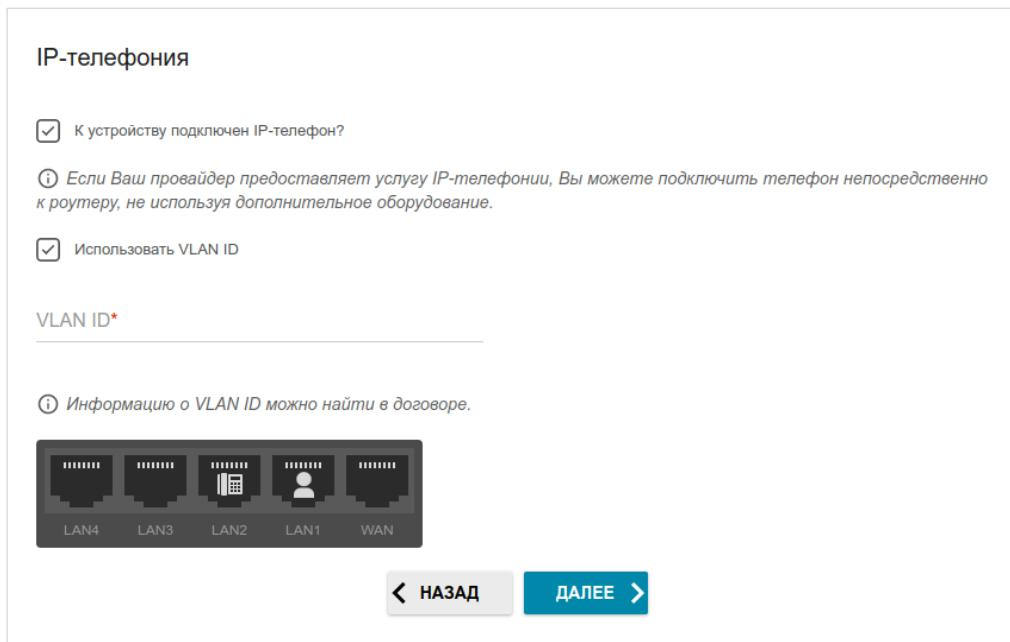
Рисунок 52. Страница выбора LAN-порта для подключения VoIP-телефона.
