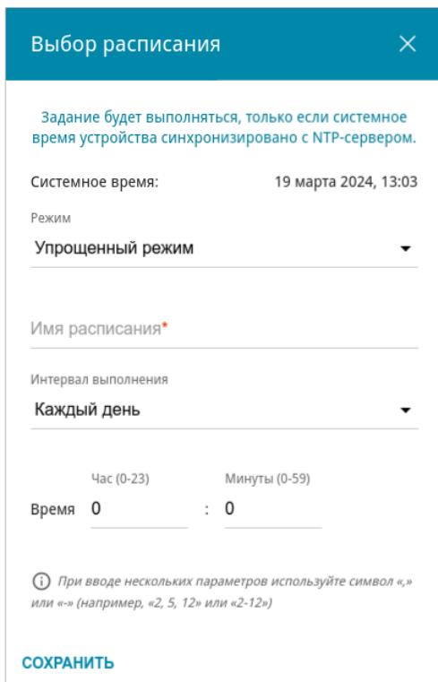
Рисунок 161. Окно настройки автоматической перезагрузки устройства по расписанию.
