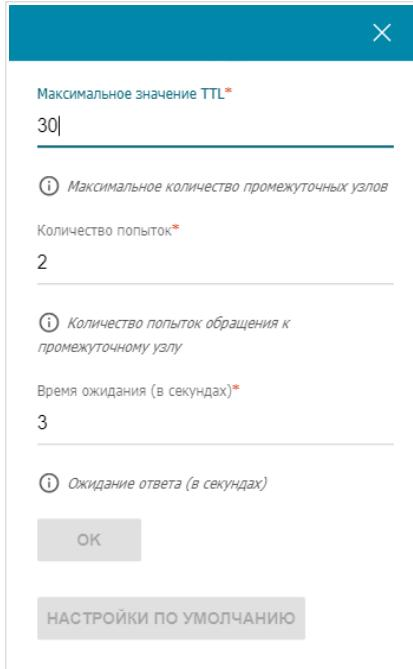
Рисунок 168. Страница **Система / Трассировка маршрута**. Окно дополнительных настроек.
