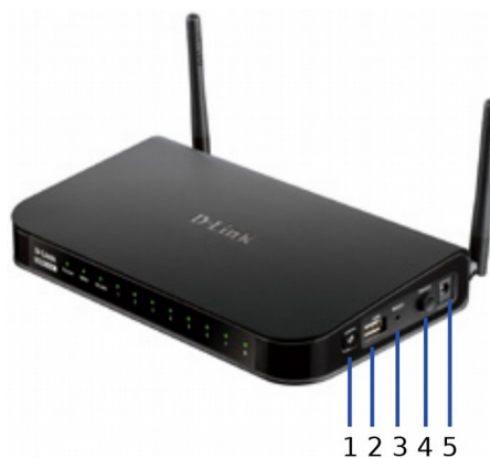
Рис. 2. Боковая панель DSR-150N
