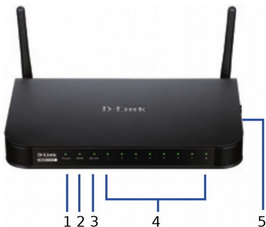
Рис. 1. Передняя панель DSR-150N
