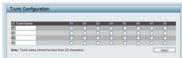
Рисунок 26. Configuration > Trunk (Агрегирование каналов)
