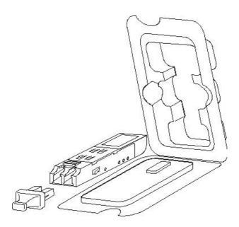
Figure 1-8. Installing the Mini-GBIC Module
