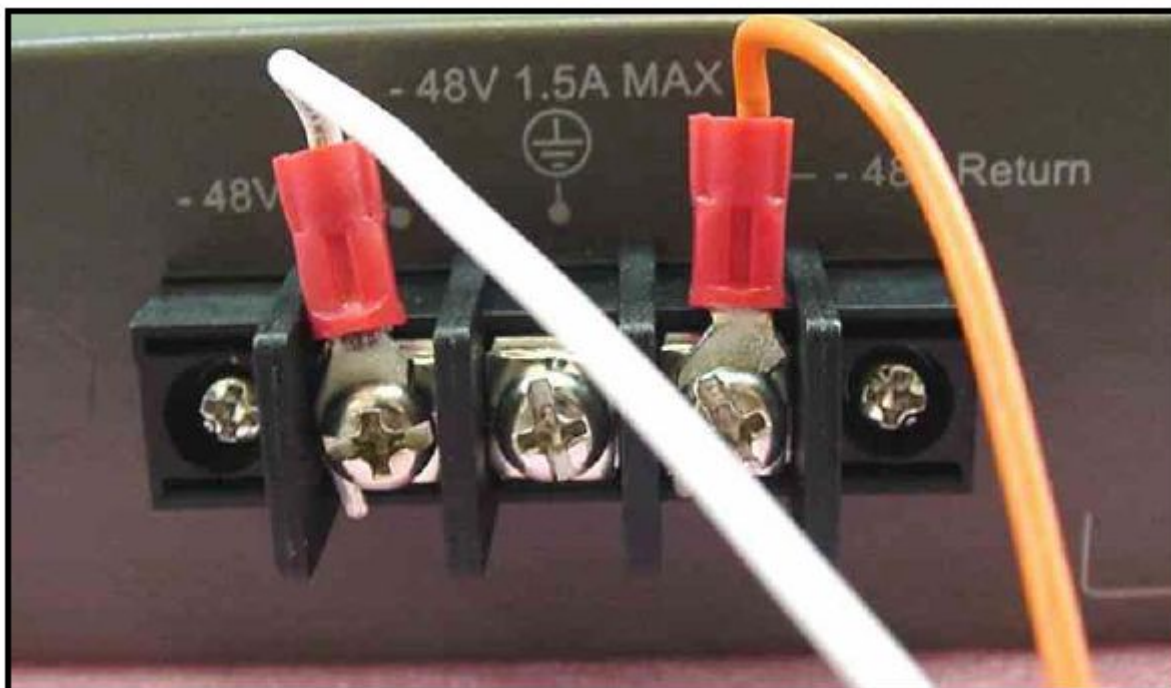
Рисунок 2.4 – Подключение блока питания к источнику постоянного тока
