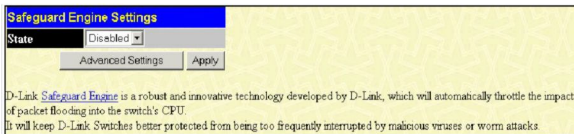
Рисунок 7- 41. Окно Safeguard Engine
