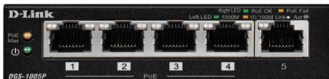
Благодаря индикаторам можно осуществлять мониторинг, выполнять диагностику, поиск и устранение проблем в соединении, на коммутаторе или подключенных устройствах.
