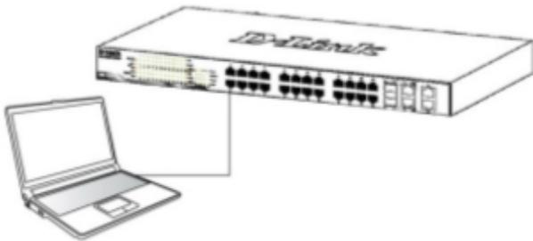
2. Для выполнения входа в Web-интерфейс компьютеру должен быть назначен IP-адрес из того же диапазона, в котором находится IP-адрес коммутатора. IP-адрес коммутатора по умолчанию – 10.90.90.90, маска подсети – 255.0.0.0, шлюз по умолчанию – 0.0.0.0.
