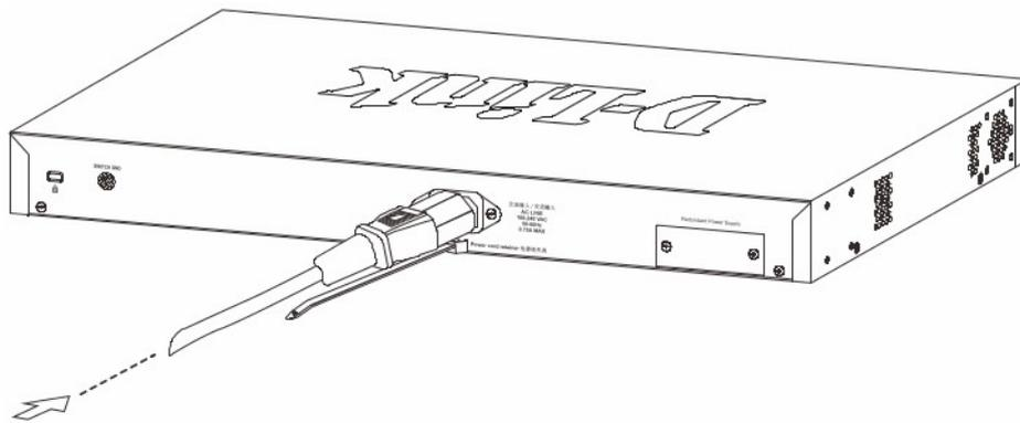
**Рисунок 6 — Подключение кабеля питания к коммутатору**
