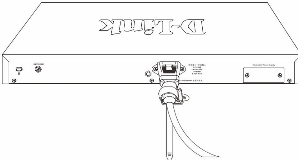
Рисунок 9 — Фиксация кабеля питания
