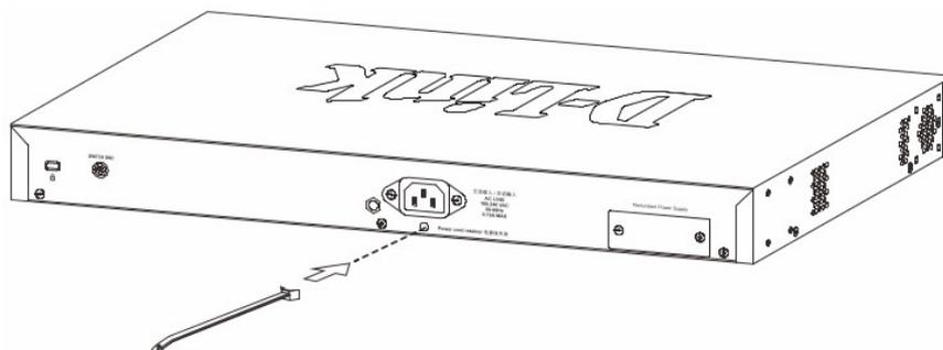
Рисунок 5 — Установка кабельной стяжки на коммутатор
