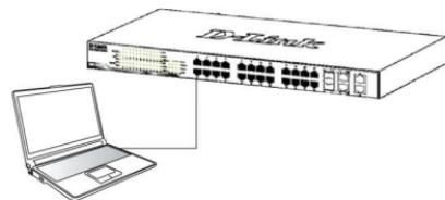
Рисунок 7. Подключение Ethernet-кабеля
