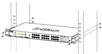
Рисунок 5. Установка коммутатора в стандартную стойку
