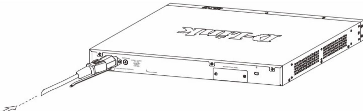
**Рисунок 9 — Подключение кабеля питания к коммутатору**
