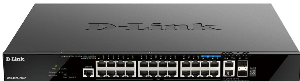
**Рисунок 1 — Передняя панель DGS-1520-28MP**
