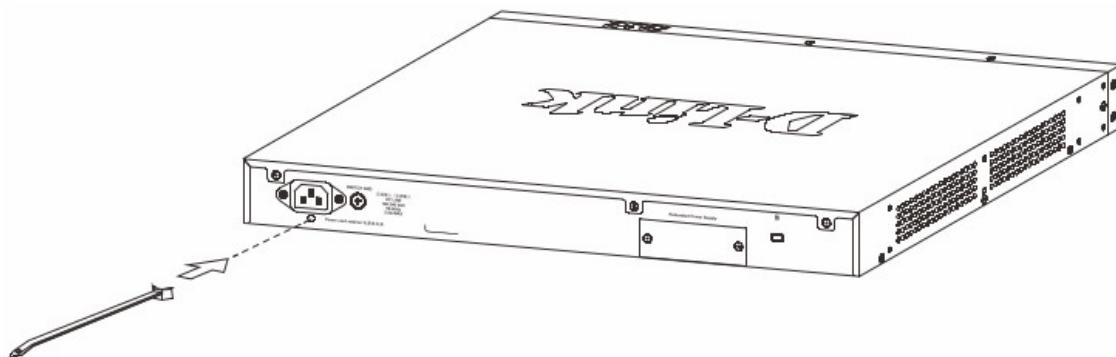
**Рисунок 8 — Установка кабельной стяжки на коммутатор**
