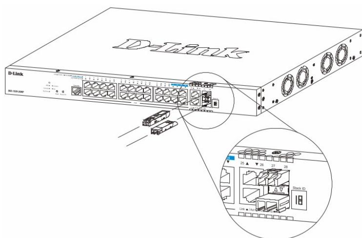
Рисунок 7 — Подключение трансиверов к коммутатору
