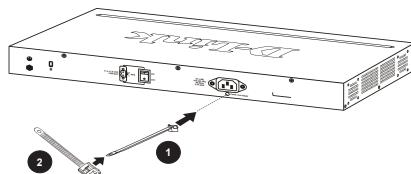
3. Conecte el cable de alimentación al comutador.
