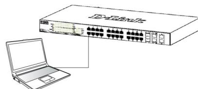
2. Konfigurasi alamat IP PC berada di segmen jaringan yang sama dengan switch. Alamat IP default switch adalah 10.90.90.90, dengan subnet mask 255.0.0.0.
