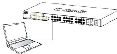
2. Configurare l'indirizzo IP del PC nel segmento di rete come switch. L'indirizzo IP predefinito dello switch è **10.90.90.90**, mentre la subnet mask è **255.0.0.0**.
