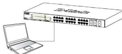
2. Для выполнения входа в Web-интерфейс компьютеру должен быть назначен IP-адрес из того же диапазона, в котором находится IP-адрес коммутатора. IP-адрес коммутатора по умолчанию - 10.90.90.90, маска подсети - 255.0.0.0.
