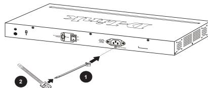
3. Schließen Sie das Netzkabel an den Switch an.
