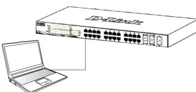
2. 電腦必須取得與交換器相同網段的IP位址，始可透過乙太網路線連結登入與設定交換器，交換器的IP位址原廠設定值為10.90.90.90，子網路遮罩為255.0.0.0。
