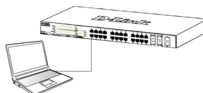
2. Configure la dirección IP del PC para que esté en el mismo segmento de red que el comutador. La dirección IP predeterminada del comutador es **10.90.90.90**, con máscara de subred **255.0.0.0**.
