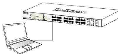
2. Konfigurieren Sie die IP-Adresse des PCs so, dass sie im gleichen Netzwerksegment wie der Switch ist. Die standardmäßige IP-Adresse des Switch lautet **10.90.90.90** und die Subnetzmaske ist **255.0.0.0**.
