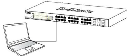
PCのIPアドレスを、スイッチと同じネットワークセグメントのものに設定します。スイッチのデフォルトIPアドレスは、10.90.90.90、サブネットマスクは255.0.0.0です。
