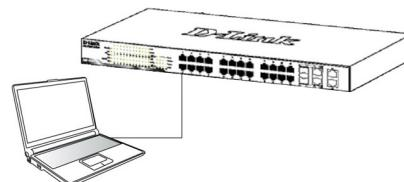
2. Configurez l'adresse IP du PC pour qu'elle se trouve dans le même segment de réseau que le commutateur. L'adresse IP par défaut du commutateur est 10.90.90.90, le masque de sous-réseau étant 255.0.0.0.
