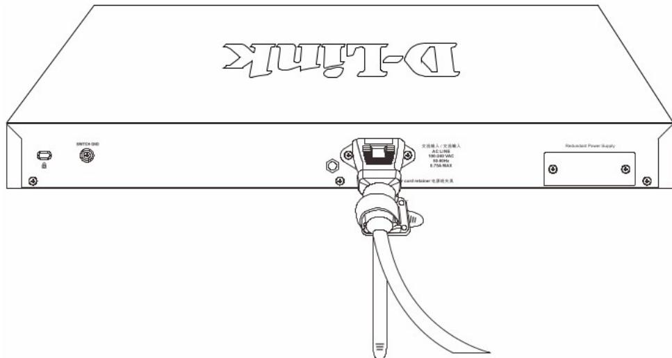
Рисунок 9 — Фиксация кабеля питания
