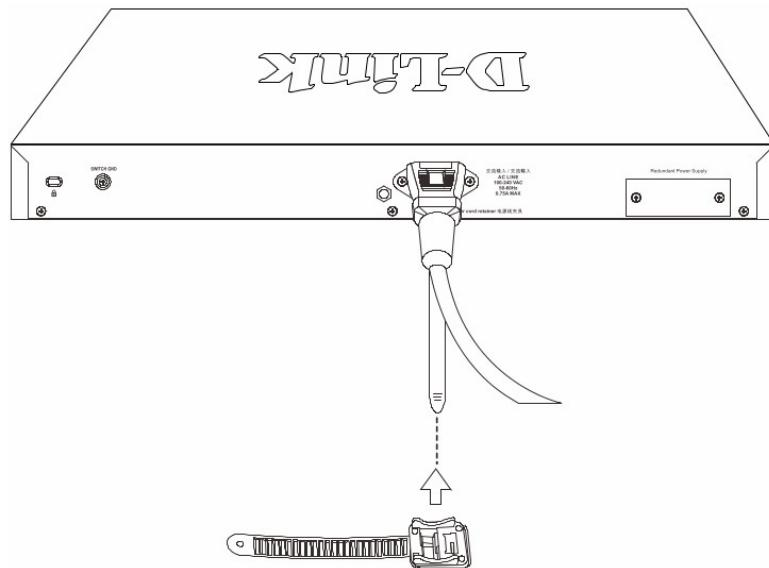
**Рисунок 7 — Установка зажима на стяжку**
