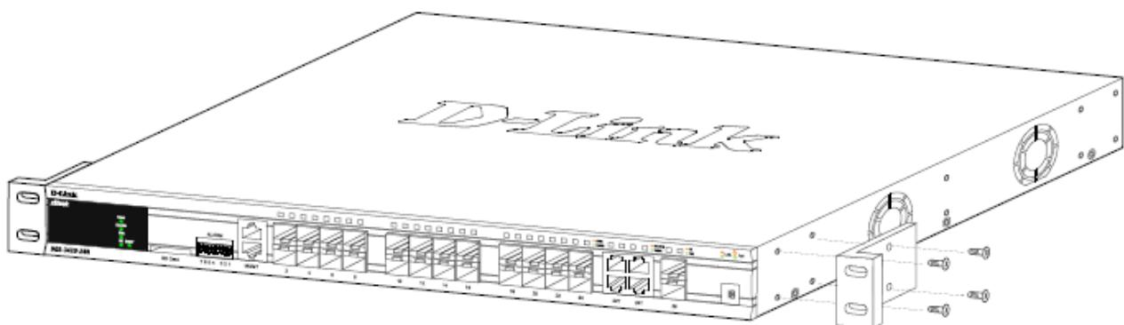
Установите коммутатор в стойку и закрепите его с помощью винтов, входящих в комплект поставки.
