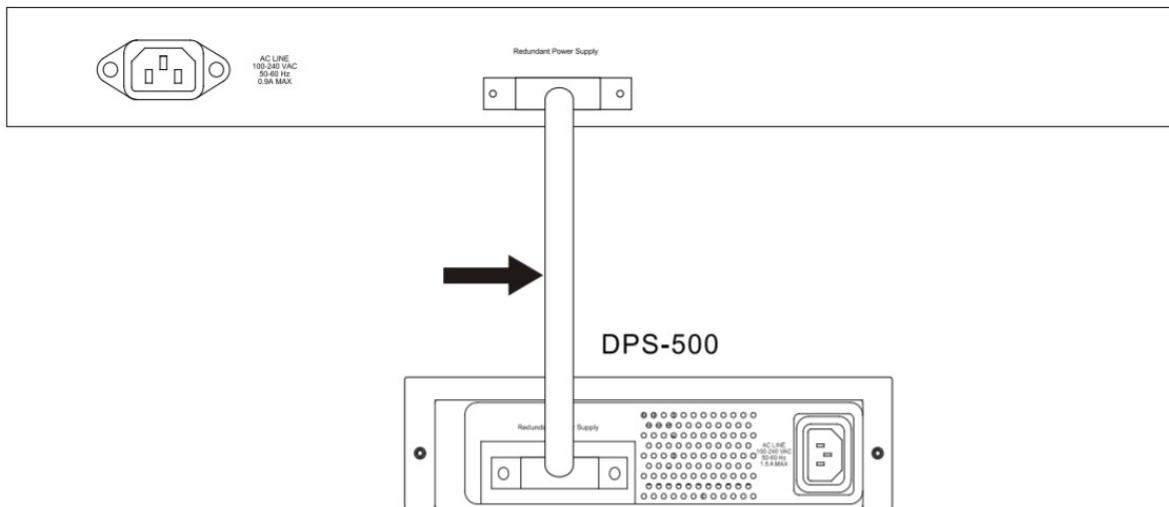
1. Подключите 14-контактный кабель к DPS-500 и к разъему RPS коммутатора.
