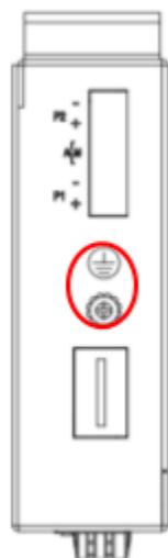
Рисунок 4 — Винт заземления на коммутаторе
