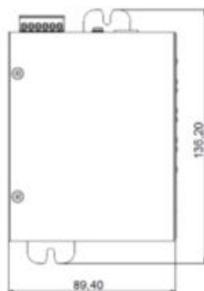
Рисунок 3 — Коммутатор с прикрепленными кронштейнами для монтажа на стену
