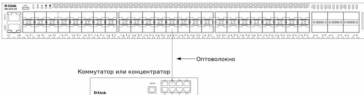
Рис. 22. Подключение коммутатора к другому коммутатору/концентратору
