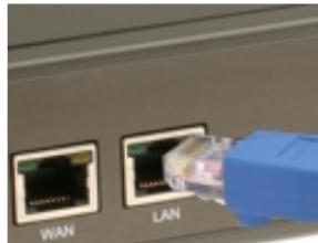
из четырех портов LAN на задней панели DVG-6004S. Другой конец оставьте подключенным к компьютеру.
