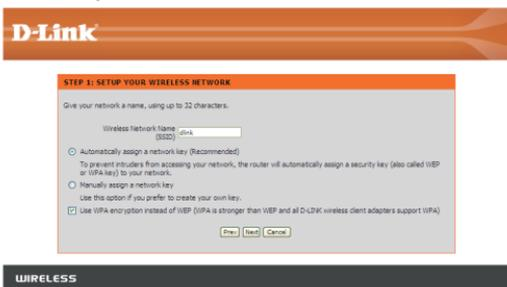
Если выбрано шифрование по протоколу WPA-PSK, то следующий экран отобразит сетевой ключ, который необходимо ввести на беспроводных клиентах.
