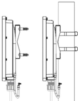
Прикрепите провод заземления к основанию. Убедитесь, что основание подсоединено к заземляющему устройству.
