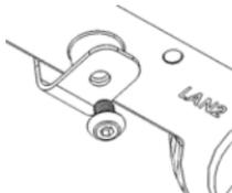
Для фиксации DAP-3662 на мачте/стене используйте крепежный винт с шестигранным отверстием (входит в комплект поставки).
