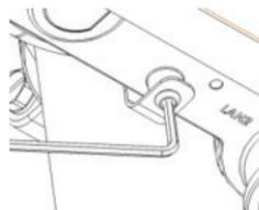
С помощью шестигранного ключа (входит в комплект поставки) затяните крепежный винт до тех пор, пока DAP-3662 не будет зафиксирована.
