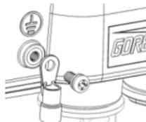
Прикрепите провод заземления к DAP-3662 с помощью входящего в комплект поставки винта.
