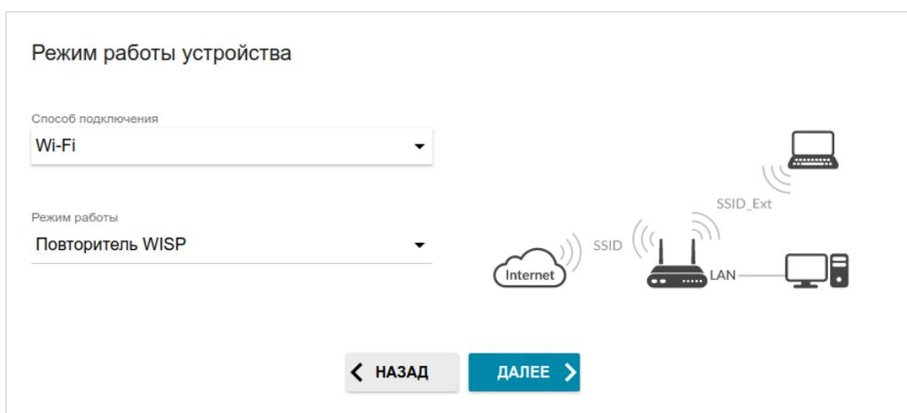
Рисунок 37. Выбор режима работы устройства. Режим **Повторитель WISP**.
