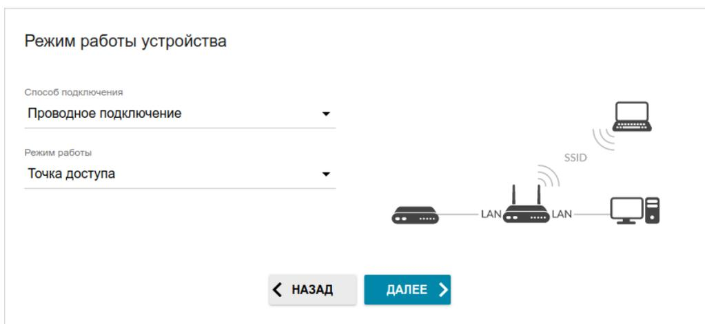
Рисунок 38. Выбор режима работы устройства. Режим **Точка доступа**.
