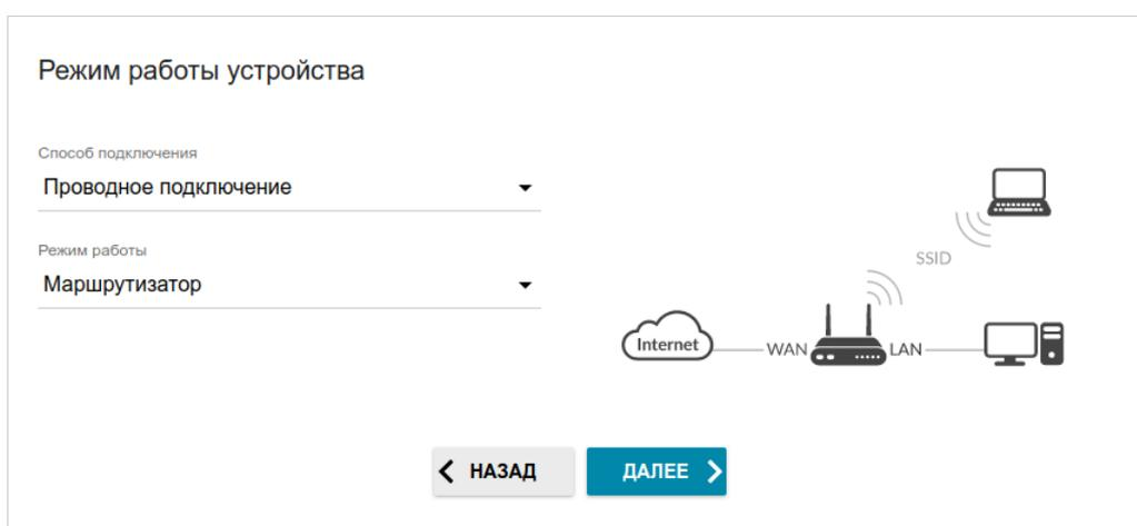
Рисунок 36. Выбор режима работы устройства. Режим **Маршрутизатор**.
