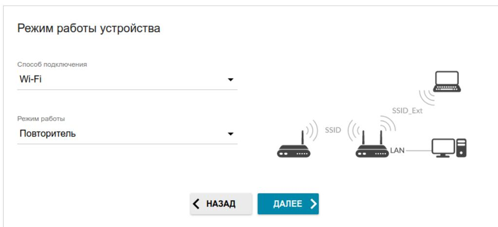
Рисунок 39. Выбор режима работы устройства. Режим **Повторитель**.
